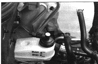
Contrôle du niveau du liquide de frein dans le réservoir de compensation.
